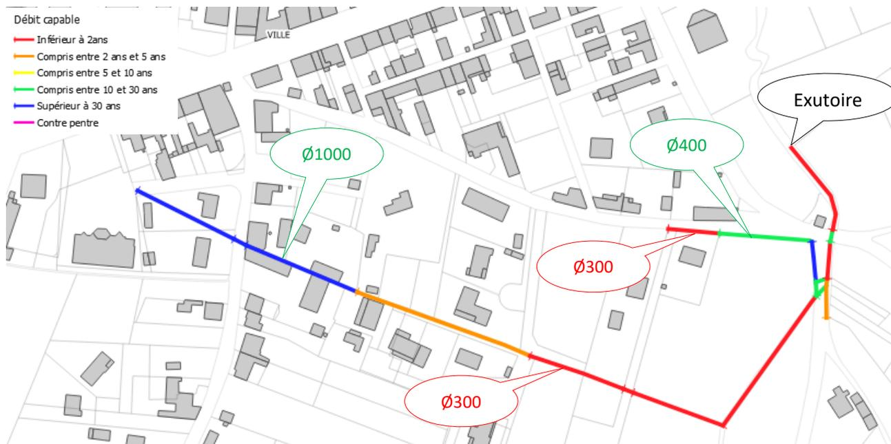
Dans le boulevard de la Fontaine, la buse  $\varnothing 400$  mm permet de faire transiter a minima le débit pointe décennal alors que la buse  $\varnothing 300$  mm en amont immédiat de celle-ci présente une capacité hydraulique inférieure au débit de pointe biennal.
